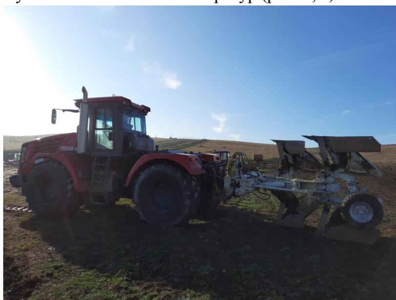
Рис. 4. Трактор с плантажным плугом.
